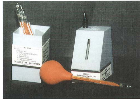
Abb. 14: Strömungsprüfer für Luft zum Sichtbarmachen von Luftströmungen bei Undichtheiten, Strömungsprüfröhrchen-Set
